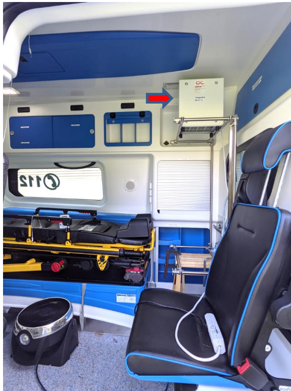
Abbildung 2 Versuchsaufbau im KTW. Der Ionisator befindet sich oben rechts auf dem Edelstahlrahmen.
